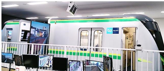
実際の訓練車両では困難な、自然災害 事故・故障がプログラムされ、遠隔スイッチで再現し、**事故発生時の初期対応を訓練**する。
